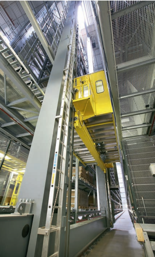
Die zweisäuligen MTwin Regalbediengeräte sind auf hohe Traglasten ohne Einbußen hinsichtlich Geschwindigkeit und Beschleunigung ausgelegt.
